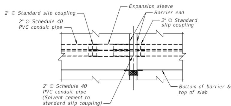
**CONDUIT EXPANSION JOINT DETAIL**
